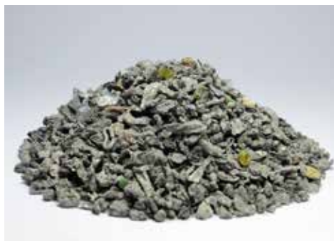
▲ Aus Aluminium-Granulaten (hier 5–8 mm) entstehen neue Aluminiumlegierungen für die Automobilindustrie.
