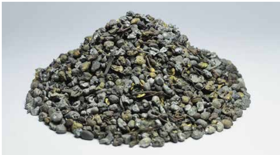
▲ Die schweren Nichteisenmetall-Granulate (hier: 5–8 mm) zeichnen sich durch hohe Edelmetallgehalte aus
